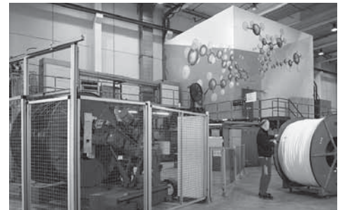
Rysunek 42 Bunkier w którym odbywa się proces sieciowania
