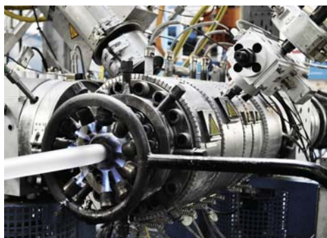
Rysunek. Ekstruder do wytłaczania rur.
