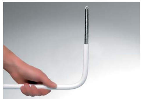
Rysunek. Prawidłowe gięcie rury (2).
