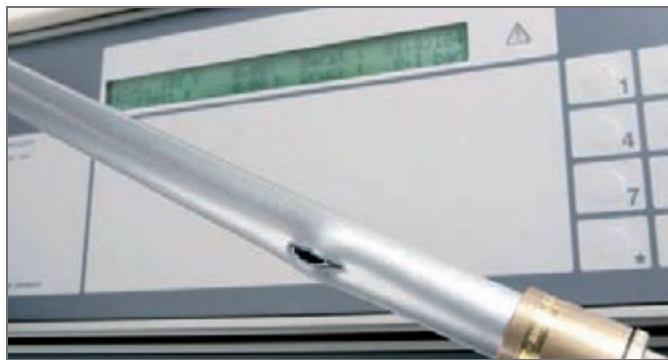
Rys. 4-5 Wynik badania ciśnienia rozrywającego z rurą uniwersalną RAUTITAN flex
