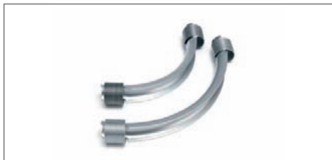
Rys. 13-5 Łuk prowadzący do instalacji wody pitnej (4 x d) - 90° i łuk prowadzący do instalacji wody pitnej/grzewczych (5 x d) - 90° dla średnicy DN 32.
