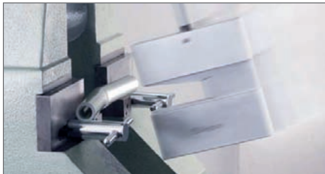
Rys. 4-6 Rura uniwersalna RAUTITAN flex w urzędzeniu do badania udarności
