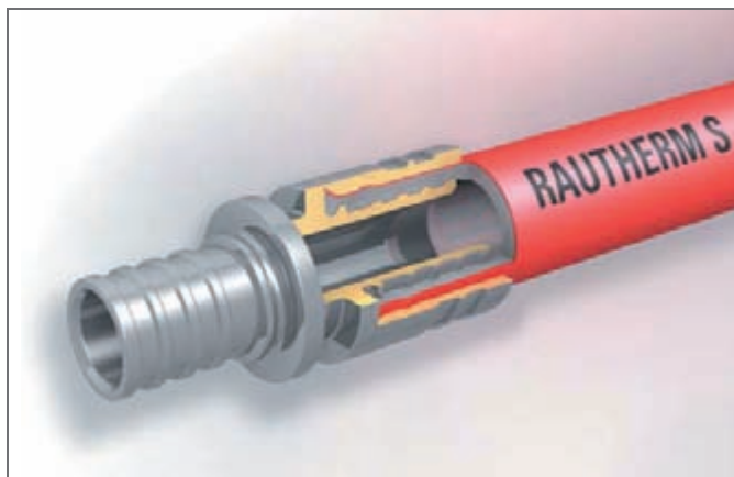
Rys. 6-5 Rura grzewcza RAUTHERM S
