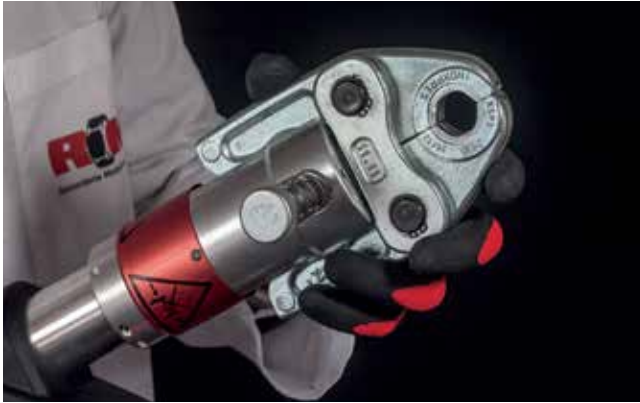
Preparazione della macchina pressatrice / Press machine preparation
