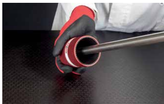
Sbavatura del tubo / Deburring the pipe
