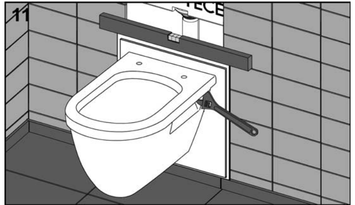
Wypoziomować płytę szklaną i zamontować ceramikę WC.
