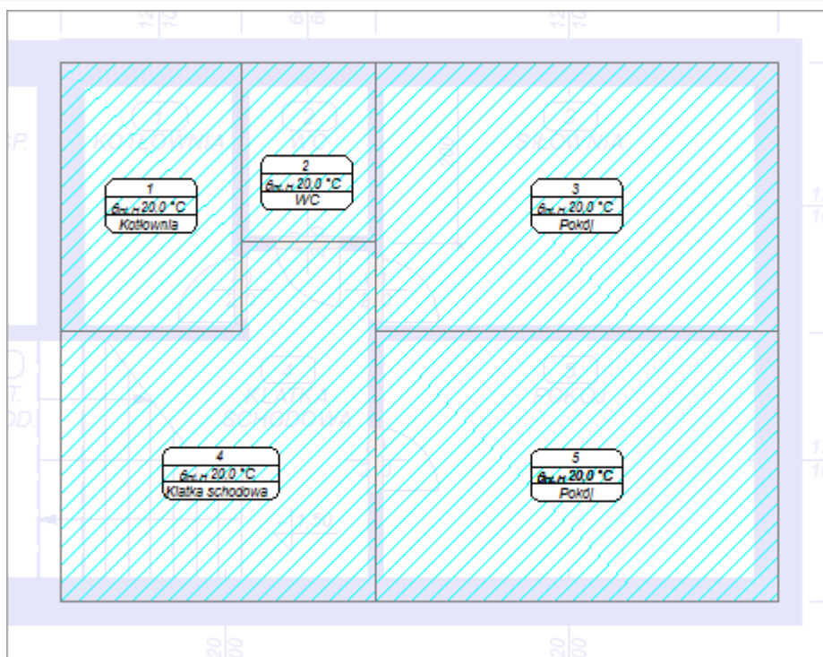
Model budynku po wstawieniu stref pomieszczeń (rzut, program w trybie rysowania stref pomieszczeń)
