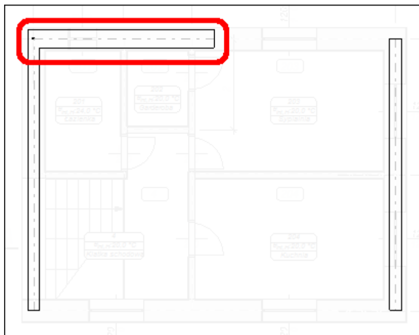
Ściana pomocnicza ułatwiająca narysowanie dachu
