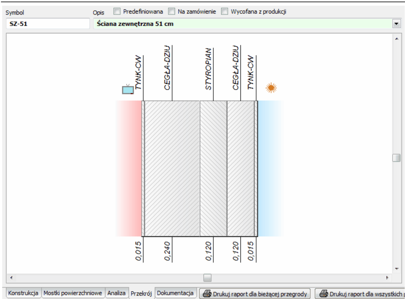
Przekrój przez przegrodę
